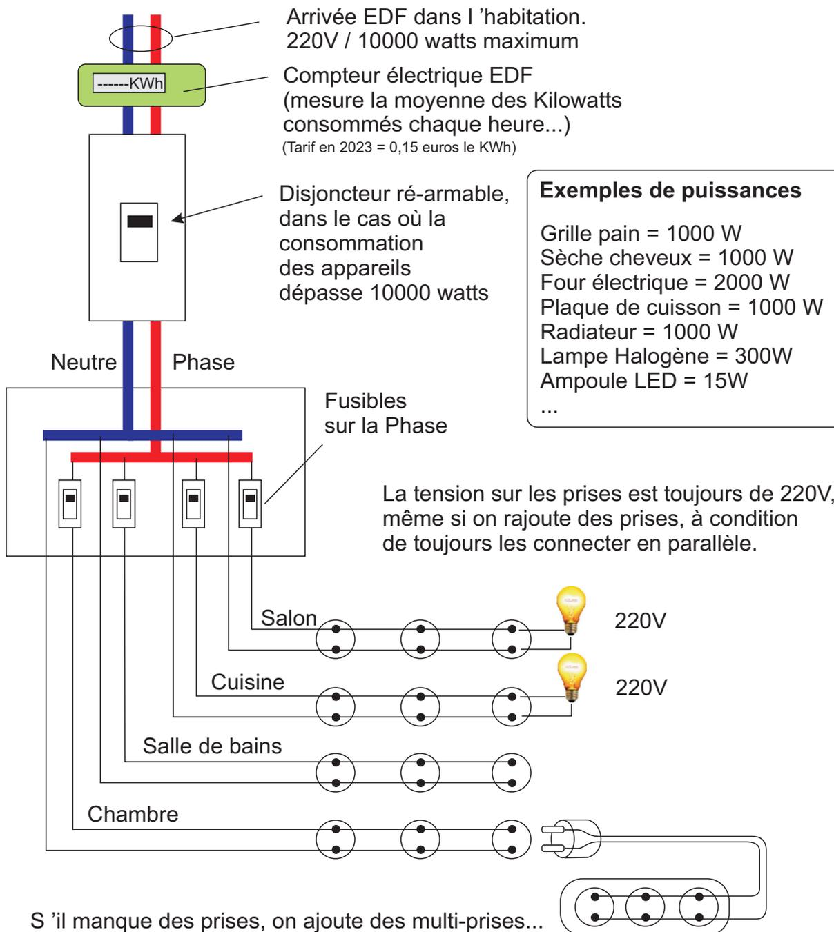
Ceci est un schéma de principe, il manque les prises de terre obligatoires pour les pièces humides (Cuisine, Salle d'eau...).
