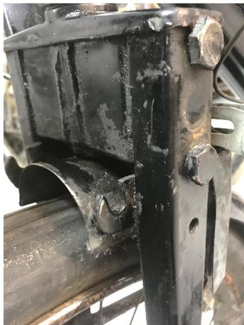
*L'utilisation des deux vis de fixation des fourches avant du Solex*
