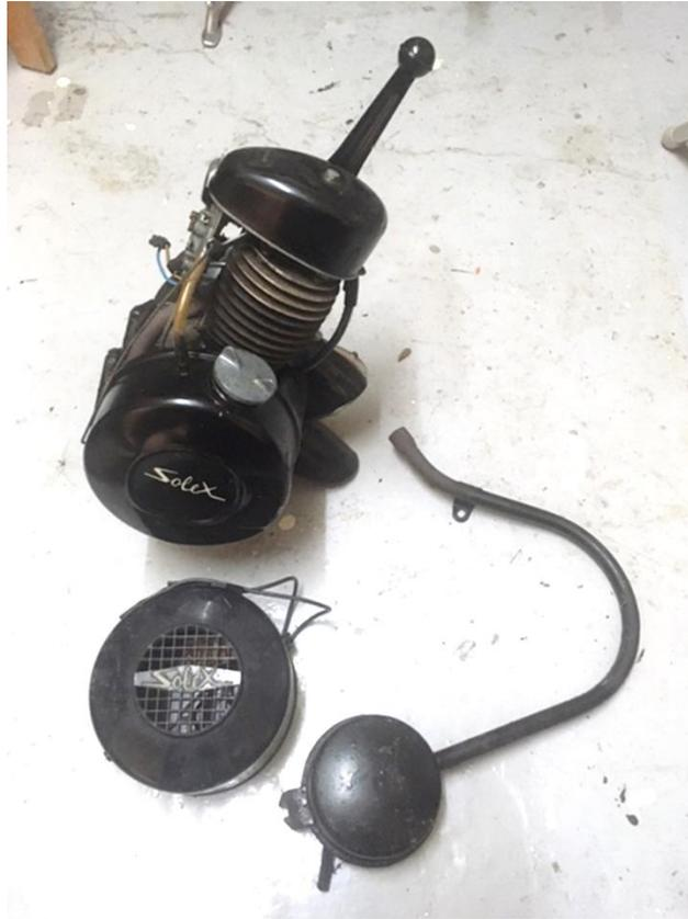
*Cinq vis retiennent le moteur, le réservoir et le pot d'échappement*
