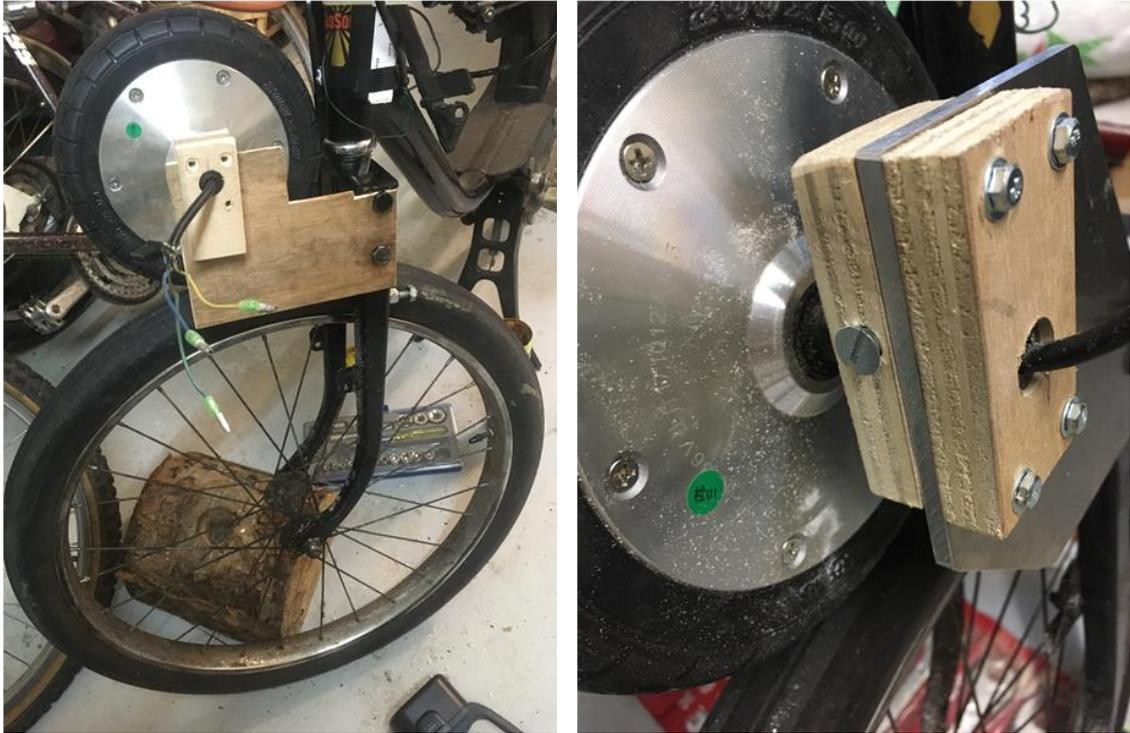
*La fixation du moteur pour essai sur une plaque en bois puis sur une plaque d'aluminium d'épaisseur 5mm*
