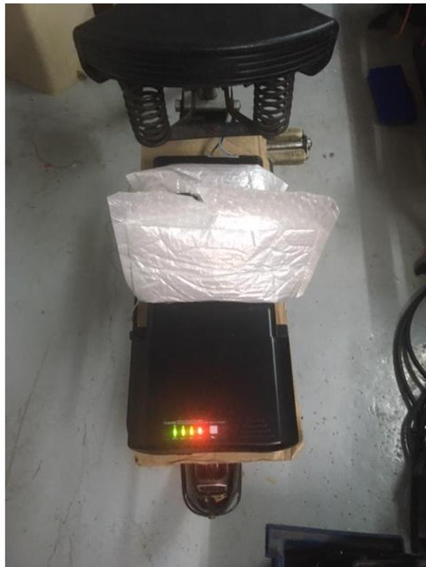
*La batterie au lithium 36V 10Ah sur le porte bagage.*
