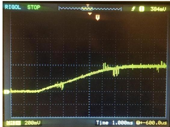
*Solution 20kHz ( rampe de 5ms déterminée par la valeur de la self )*
