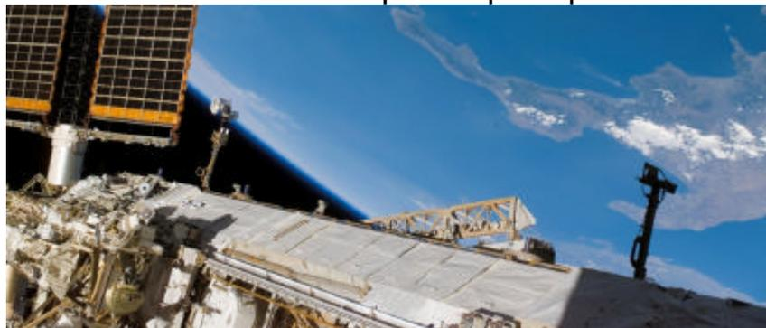
Pour profiter pleinement du soleil, les panneaux solaires sont orientables et tournent lentement sur eux-mêmes (comme des ailes de moulin à vent), grâce à un système de moteurs et d'engrenages situés à chaque extrémité de la poutre principale :
