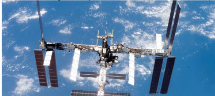
En orbite basse (400 Km), l'ISS passe alternativement du jour à la nuit par cycles de 90 minutes. Les panneaux solaires ne fournissent donc pas d'électricité pendant les 45 minutes d'obscurité. Il faut alors profiter des 45 minutes d'éclairement pour charger les nombreuses batteries, situées à l'intérieur de la poutre principale :
